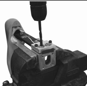
Bor to hull på 8,1 diameter.
