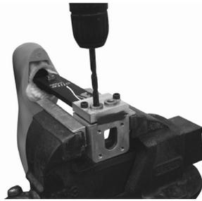
Zwei Löcher mit einem Durchmesser von 8,1 in die Bohrbuchsen bohren.
