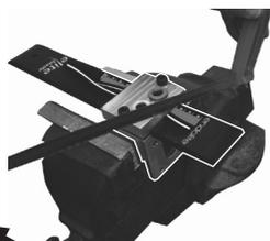
Retire el encaje, sitúe la sujeción de colocación en la mordaza y corte la pala. Coloque los tornillos con resalte para evitar daños en los componentes.
