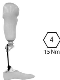
Montare l'invasatura sull'alloggiamento superiore del morsetto e serrare le viti della piramide (15 Nm). Fare riferimento alla pagina che descrive l'allineamento per la configurazione iniziale.
