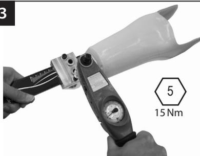
Stram til festeklemmeboltene til 15 Nm (sjekk hver skrue minst to ganger).
