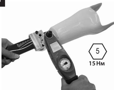
Затяните крепежные болты обрезного стяжного адаптера-кондуктор с усилием 15 Нм (дважды проверьте затяжку болтов).
