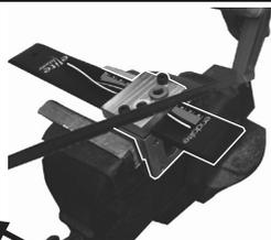
Снимите гильзу, аккуратно зажмите обрезной стяжной адаптер-кондуктор в тисках и обрежьте по длине. Для предотвращения повреждения компонентов установите предохранительные винты с буртиком.
