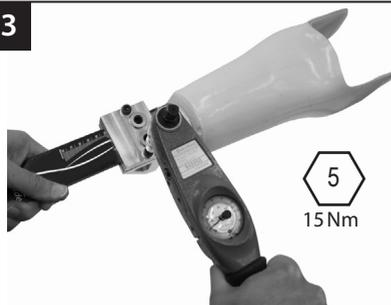
Serrare i bulloni del morsetto a 15 Nm (controllare ogni vite almeno due volte).
