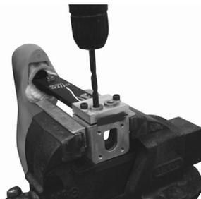
Forez deux trous d'un diamètre de 8.1 à l'aide de douilles-guides de perçage.
