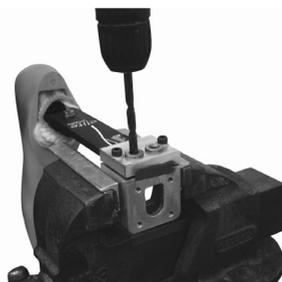
Trapanare due fori di diametro 8,1 attraverso le apposite boccole.
