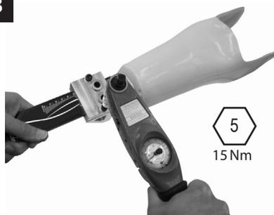
Serrez les boulons du collier de serrage sur un couple de 15 Nm (Vérifiez au moins deux fois chaque vis).
