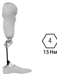
Установите гильзу на верхней части обрезного стяжного адаптера-кондуктора и затяните установочные винты пирамидного адаптера с усилием в 15Нм. См. описание проведения юстировки при начальной настройке.
