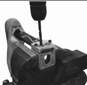
Аккуратно просверлите два отверстия диаметром 8,1мм через соответствующие отверстия в обрезном стяжном адаптере-кондукторе.
