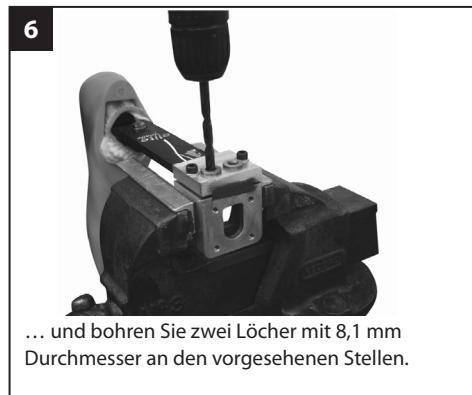
... und bohren Sie zwei Löcher mit 8,1 mm Durchmesser an den vorgesehenen Stellen.
