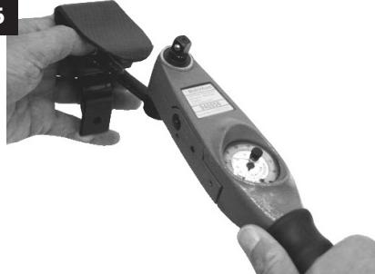
Montez la nouvelle lame de talon, appliquez de la Loctite (243) et serrez les vis (15 Nm). (Utilisez l'embout de clé dynamométrique 940081.)
