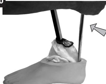
Con l'ausilio di una leva, agevolare l'ingresso del gruppo nel rivestimento...
