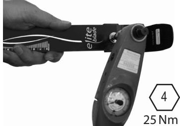
Sujete la ballesta tibial al dispositivo. Péguelo con Loctite (243) y apriete el tornillo (25 Nm)
