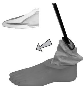
Coloque el ensamblaje enganchando la punta de la ballesta en la ranura interna de la cubierta cosmética del pie
