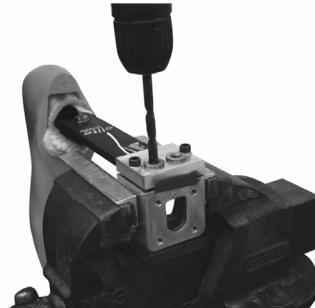
...e praticare due fori del diametro di 8,1 attraverso le boccole di foratura.
