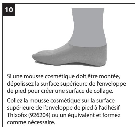
Si une mousse cosmétique doit être montée, dépolissez la surface supérieure de l'enveloppe de pied pour créer une surface de collage.
