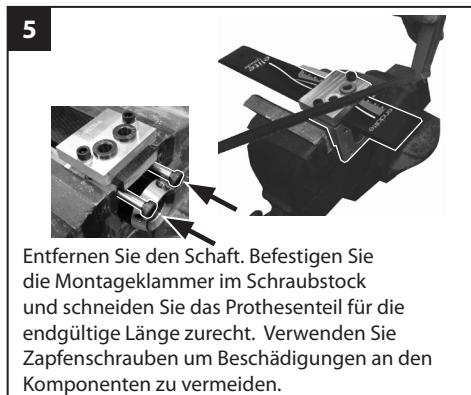
Entfernen Sie den Schaft. Befestigen Sie die Montageklammer im Schraubstock und schneiden Sie das Prothesenteil für die endgültige Länge zurecht. Verwenden Sie Zapfenschrauben um Beschädigungen an den Komponenten zu vermeiden.
