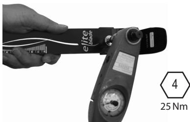
Befestigen Sie die Vorfußfeder am Mittelteil der Prothese. Sichern Sie die Schrauben mit Loctite (243) und ziehen Sie diese mit einem Anzugsdrehmoment von (25 Nm) an.
