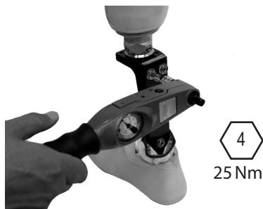
Apriete los tornillos del soporte superior (25 Nm) sellándolos con Loctite (243). Coloque y alinee el soporte piramidal.
