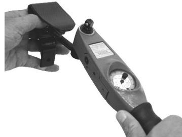
Coloque la ballesta de talón nueva, con Loctite (243) y apriete los tornillos (15 Nm). Utilice la llave inglesa del par de torsión (940081).
