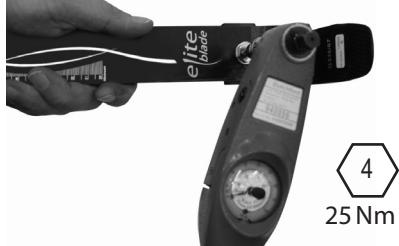
Fissare la lamina al supporto tallone. Loctite (243) e serrare i bulloni (25 Nm).
